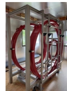
Фигура 2 Снимка на ЯМР-а в процес на изграждане. Бобините, генериращи основното магнитно поле B_0 в червено, и градиентните бобини, разположени от външната страна на основните бобини (сиви те правоъгълници). Цялата конфигурация е поставена във Фарадеева клетка, за да се ограничи външният шум.
