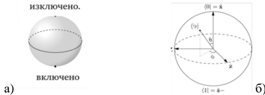
Фиг. 5 Квантов ключ и сфера на Блох: а) квантов ключ за управление; б) сфера на Блох, визуализираща квантов бит информация.
