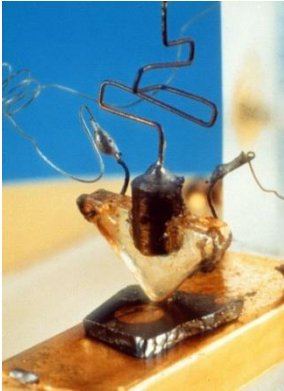
Фиг. 5а Първият точков транзистор на базата на Ge.
