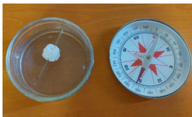
Фиг. 3 Опит с компас от намагнитена игла във вода.
